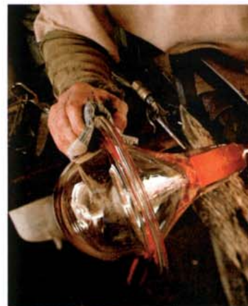
Вверху: Алисон Бергер в своем офисе в Западном Голливуде. Внизу: раскаленное стекло придерживают "варежкой" из мокрой бумаги. Три нижних фото: формовка плафонов.
